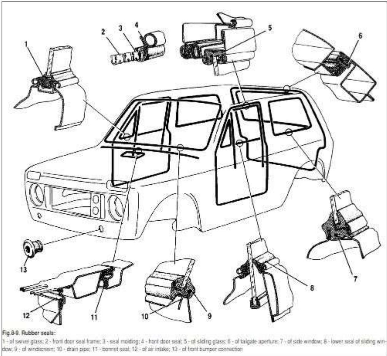
Das Seitenfenster des Lada Niva ist in einem Gummi mit einem Metallkern montiert. Siehe Abbildung unter Nummer 7. Sie sollten diesen Metallkern NICHT entfernen. Das vorhandene Fenster befindet sich zwischen dem Metallkern und dem Gummi. Sie beschädigen diesen Kern, wenn Sie ihn entfernen, bevor das Glas, einschließlich des Gummis, vom Körper entfernt wird.
